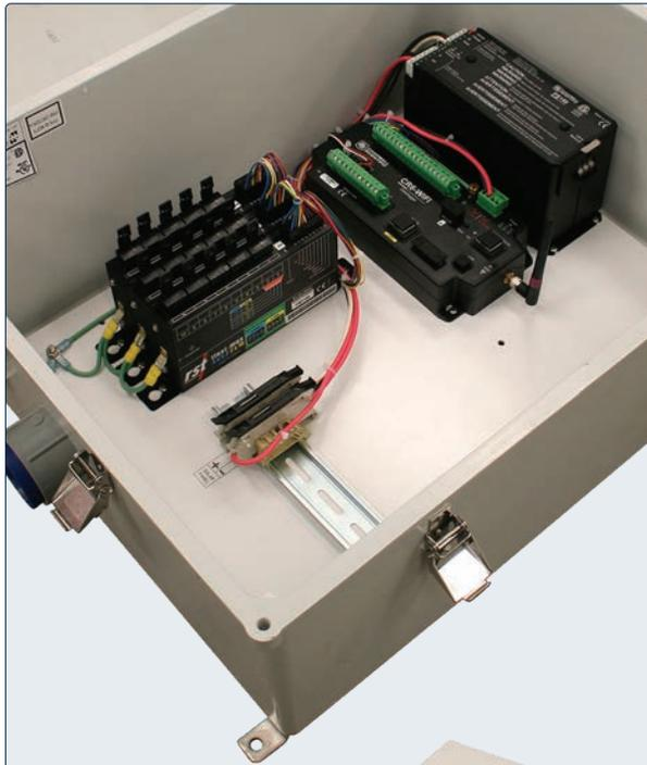
Adquisidor de datos FlexDAQ CR6 (con wi-fi opcional) en un gabinete a prueba de las intemperies con multiplexores Flexi-Mux de RST.
