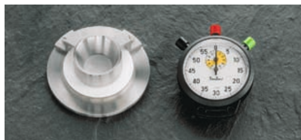
Equipo anular con papel filtrante para medición del tiempo de filtrado del agua, cronómetro
