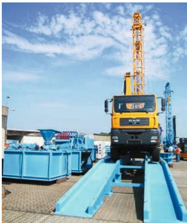
Equipo universal de perforación Prakla con sistema de depósitos de lodos
