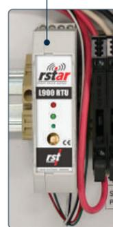
Uma caixa do FlexDAQ exibida com uma tampa aberta para ilustrar um RSTAR L900 RTU instalado (no trilho DIN), registrador de dados, rádio e alimentação de energia.
