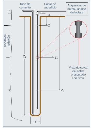
Una instalación típica de un cable de TDR con rizos en un pozo a rellenar con cemento.
